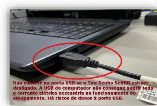
Se o sistema operacional do computador não reconhecer o dispositivo conectado como uma porta serial virtual, uma "COM", será preciso instalar ou atualizar o **driver do controlador CH340**, o conversor "Serial / USB" utilizado no Tira Senha SelfBR.
