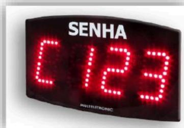
Ocorre que a letra "N", de "NORMAL", não pode ser exibida em displays de 7 seguimentos, de painéis genéricos. Então, utiliza-se o "C", de "COMUM", que pode ser exibido facilmente.
